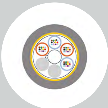
HFCL CMD 2,0 kabel światłowodowy do kanalizacji, wielotubowy
